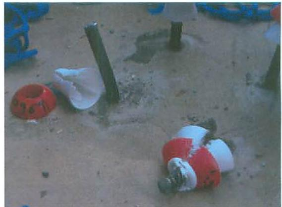
Fotografía 15: Perforaciones totales y roturas longitudinales de las protecciones
