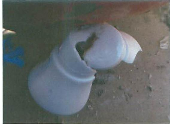
Fotografía 13: Detalle del estado de una de las protecciones que ha sufrido el impacto
