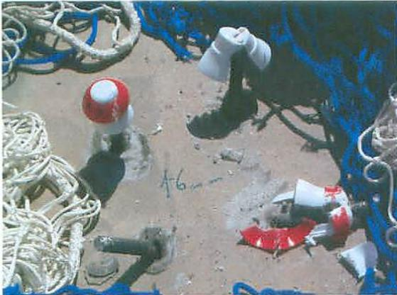
Fotografía 12: Perforación de las protecciones tras el impacto.
