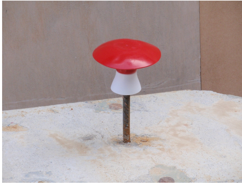
Fotografía 6: Disposición inicial de la protección para el primer impacto.
