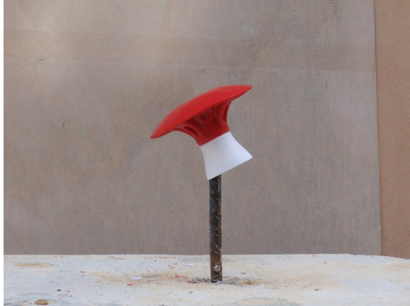
Fotografía 10: Disposición inicial de la protección sobre la barra para la realización del segundo impacto
