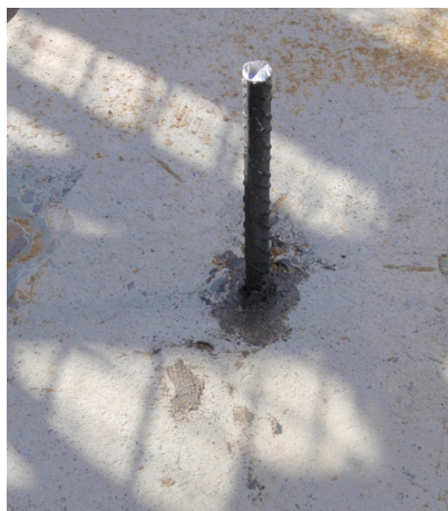
Fotografía 3: Disposición de la barra sobre la estructura soporte de ensayo.
