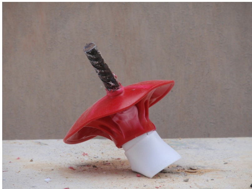
Fotografía 11: Estado de la protección tras la realización del segundo impacto. Se produce la perforación de la protección.
