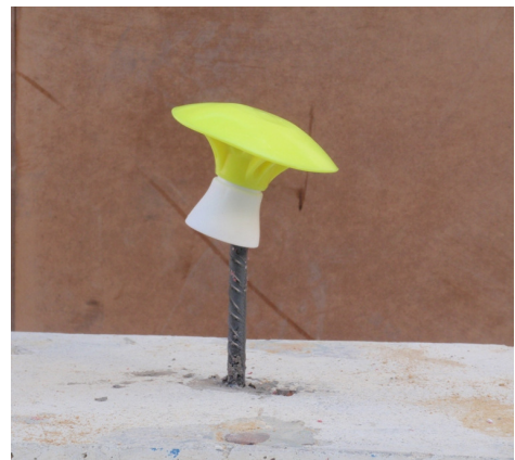
Fotografía 5: Disposición inicial de ensayo para el segundo y tercer impacto. Colocación del dispositivo de protección con el ángulo máximo sobre la barra.
