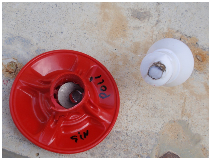
Fotografía 9: Deformaciones y roturas parciales producidas en el interior de la pieza.
