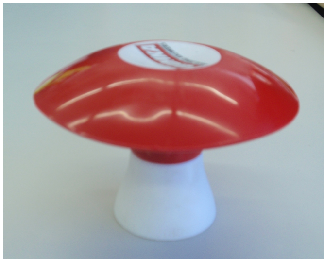
Fotografía 1: Protección para terminaciones de armadura, objeto de estudio.
