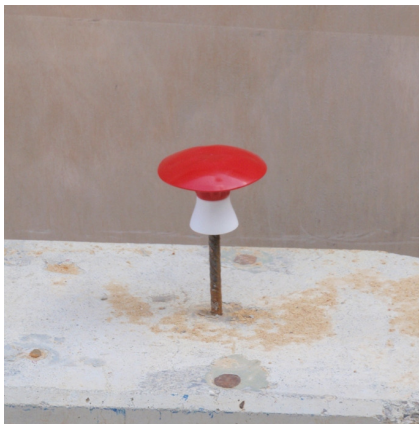
Fotografía 4: Disposición inicial de ensayo para el primer impacto. Colocación del dispositivo de protección en ángulo recto sobre la barra.
