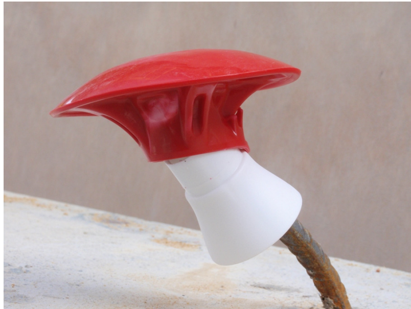
Fotografía 8: Deformaciones y roturas parciales provocadas en la seta por el impacto.
